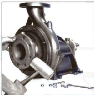
شکل ۹: جدا کردن فلنج مکش
